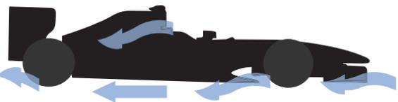
El aire que se desliza por el coche se mueve hacia atrás. Es en esta parte del monoplaza donde las moléculas de aire son interrumpidas en su salida, lo que crea un vacío de aire de baja presión
